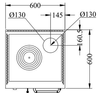
Version avec sortie de fumées à droite. La version avec sortie de fumées à gauche est symétrique.
