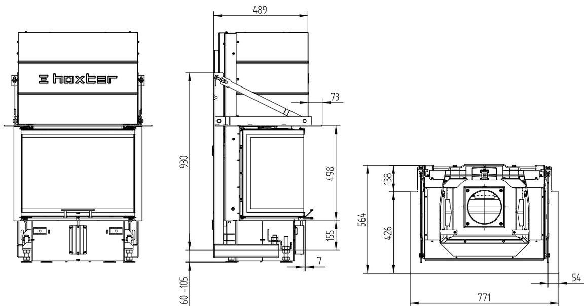
UKA 35/60/35/50Sh Ossatures incl. cadre de montage 5 côtés 70 mm
